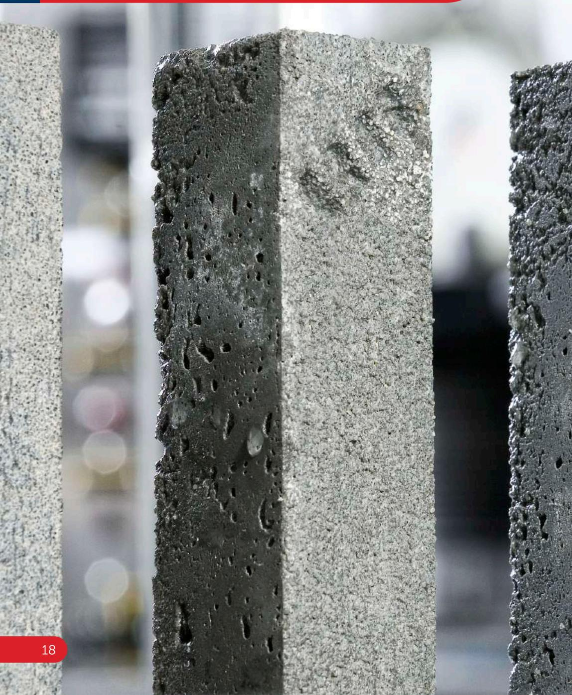
Бетоннинг кўп хусусиятлари унинг зичлигига боғлиқдир яъни, бетон зичлиги цемент тошининг зичлигига, тўлдирувчиларнинг ҳили ва тузилишига боғлиқ бўлади. Зичлиги бўйича бетонлар ўта оғир ( $2400 \text{ кг/м}^3$  ва ундан юқори), оғир ( $1800 \dots 2400 \text{ кг/м}^3$ ), енгил ( $600 \dots 1800 \text{ кг/м}^3$ ) ва ўта енгил ( $600 \text{ кг/м}^3$  дан кам) турларга бўлинади.
